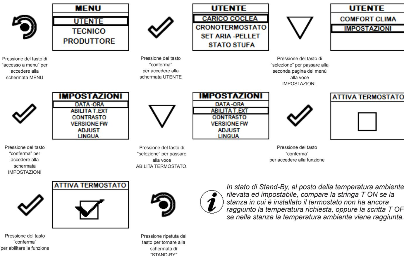
*In stato di Stand-By, al posto della temperatura ambiente rilevata ed impostabile, compare la stringa T ON se la stanza in cui è installato il termostato non ha ancora raggiunto la temperatura richiesta, oppure la scritta T OFF se nella stanza la temperatura ambiente viene raggiunta.*
