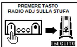
Mantenere premuto per alcuni secondi il tasto di comunicazione radio (RADIO ADJ) della scheda elettronica, posta sulla parte posteriore della stufa, per inizializzare il palmare.
