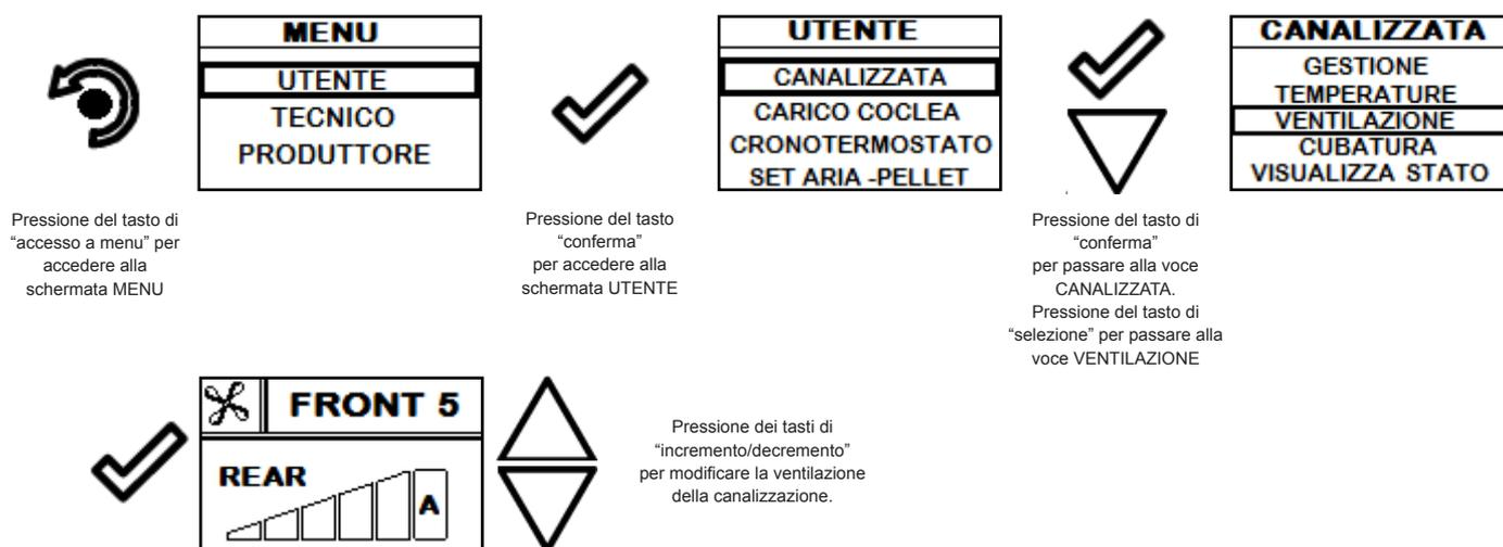
Una volta effettuato l'accesso, la riga superiore del display mostra la velocità della ventilazione frontale legata alla potenza della stufa (es.: Front 5), la potenza della canalizzazione (riga inferiore) può essere impostata con i tasti di "incremento/decremento" con valori impostabili da 0 (canalizzazione spenta) ad Auto (potenza canalizzazione che segue la potenza della ventilazione frontale); i valori intermedi impostabili sono 1 - 2 - 3 - 4 - 5.
