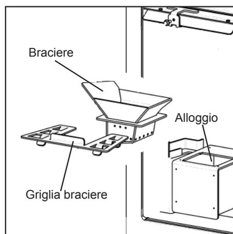
L'utilizzo di una differente partita di pellet, seppur della stessa marca, potrebbe comportare differenze di combustione che potrebbero creare maggior residuo all'interno del braciere. La corretta pulizia, fatta giornalmente, permette alla stufa di bruciare in maniera ottimale e fornire costantemente una buona resa calorica, evitando malfunzionamenti che con il passare del tempo potrebbero richiedere l'intervento del tecnico per ripristinare la macchina.
