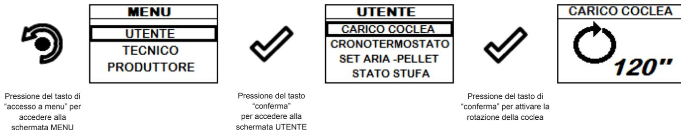
Al termine del periodo di carico coclea il display visualizza 0" e automaticamente si porta alla schermata del menù UTENTE.
