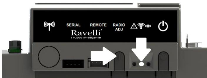
Il LED giallo lampeggiante indica che la scheda elettronica è in attesa di ricevere il segnale del palmare.
