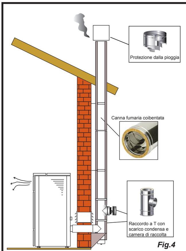
Questo tipo di installazione (Vedi Fig.4) necessita di canna fumaria coibentata, in quanto tutto il condotto fumi è stato montato all'esterno dell'abitazione. Nella parte inferiore della canna fumaria, è stato montato un raccordo di tipo "T" con tappo di ispezione.
