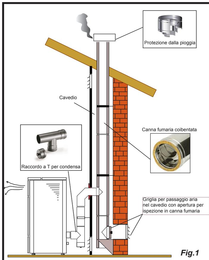
Questo tipo di installazione (Vedi Fig.1) necessita di canna fumaria coibentata nonostante tutto il condotto venga montato all'interno dell'abitazione. Inoltre la struttura deve essere inserita in un cavedio opportunamente ventilato.
