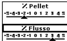
Come da esempio riportato sopra, è stata impostata una percentuale di -2 PELLETT e +3 FLUSSO, indice del fatto che un tipo di impostazione del genere è conseguenza del fatto che la combustione è carente di ossigeno e la pezzatura del pellet è piccola rispetto alla media dei 2 cm.
