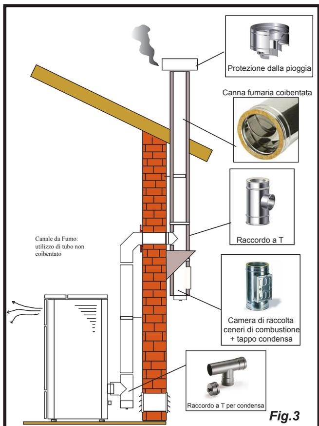
Questo tipo di installazione (Vedi Fig.3) non necessita di canna fumaria coibentata per il tratto interno dell'abitazione, mentre per il tratto posto all'esterno è obbligatorio utilizzare una tubazione coibentata. Nella parte inferiore della canna fumaria all'interno della casa è stato montato un raccordo di tipo "T" con tappo di ispezione; esternamente ne è stato montato un'altro, in modo che il tratto esterno sia ispezionabile.
