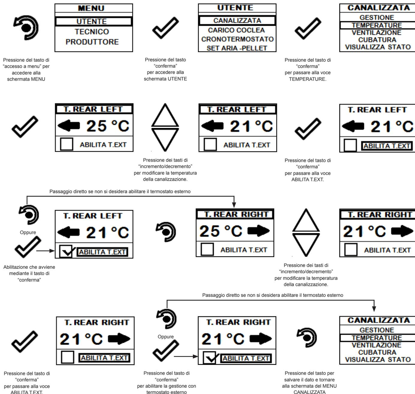
In questa modalità le due ventole lavorano a pari potenza per raggiungere i due settaggi ambiente impostati. Al raggiungimento di uno o dell'altro settaggio, la ventilazione nella stanza satura tende a ridursi al minimo, aumentando la ventilazione della stanza ancora da portare in temperatura. La condizione iniziale si può ripresentare, se le temperature nelle due stanze richiederanno ancora calore. Il tutto avviene in modo automatico.
