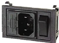
Collegare il cavo di alimentazione prima sul retro della stufa e poi ad una presa di corrente a parete. L'interruttore in figura I/O deve essere posizionato su I per alimentare la stufa. In caso di mancata alimentazione controllare lo stato del fusibile posto nel cassetto sotto l'interruttore (fusibile da 4A). Durante il periodo di inutilizzo, è consigliabile togliere il cavo di alimentazione della stufa.
