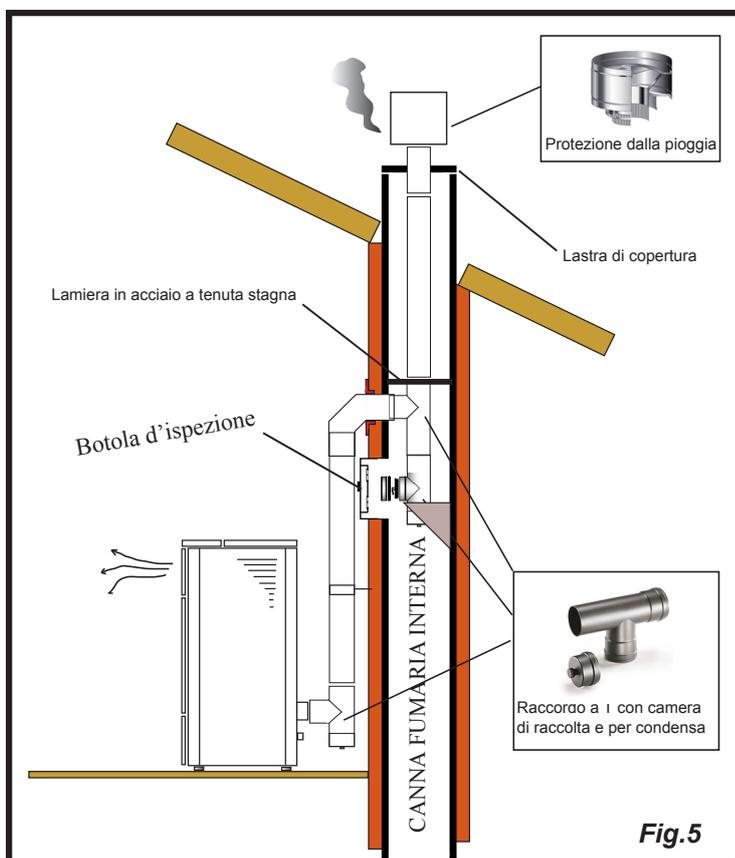
Questo tipo di installazione (Vedi Fig.5) non necessita di canna fumaria coibentata, in quanto parte del condotto fumi è stato montato all'interno dell'abitazione, e parte è situata all'interno di una canna fumaria già esistente.
