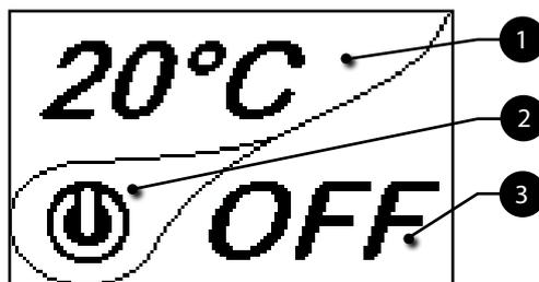
**i** Dopo 5 minuti di inattività, il display del palmare si oscura passando in modalità "SLEEP", pur mantenendo la connessione radio con la stufa. Una successiva pressione del tasto ON/OFF riattiva il display.
