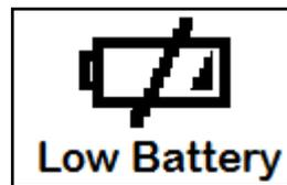
Non appena il livello di batteria non permette in alcun modo la comunicazione radio, il palmare mostra a schermo intero l'immagine della batteria scarica, bloccando tutte le funzioni del palmare fino ad avvenuta sostituzione delle batterie.
